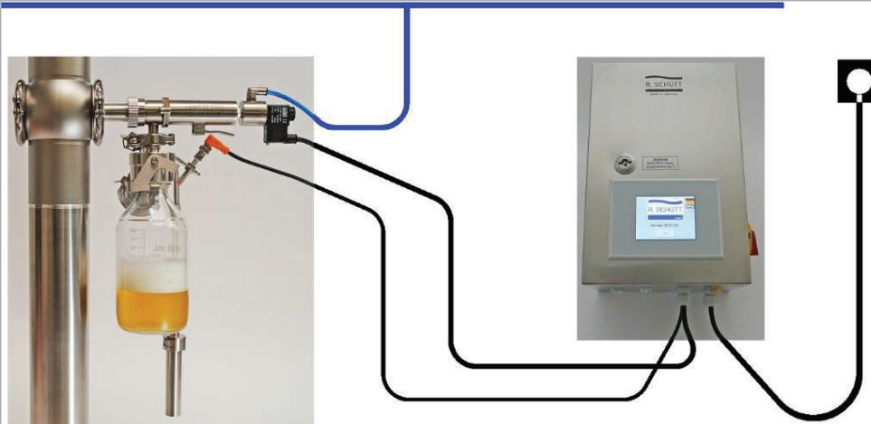
Probenahmestelle mit einer Steuerung für einen Probenehmer.
