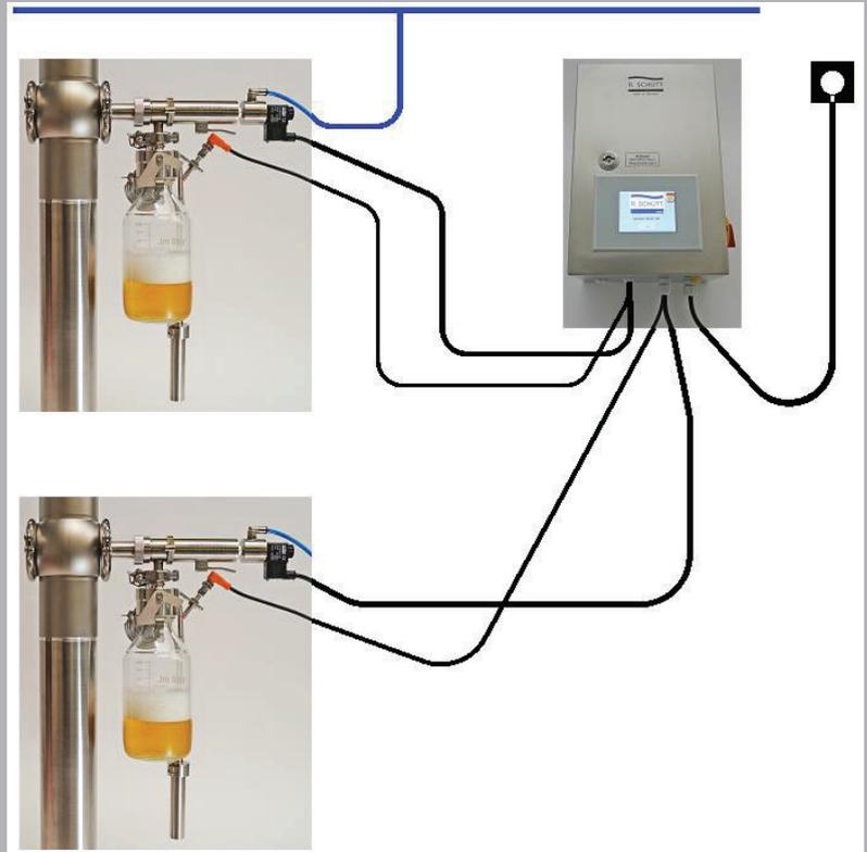
Steuerungen für mehr als zwei Probenehmer sowie Steuerungen für Probenehmer mit Reinigungs- und CO<sub>2</sub>- Ventil sind ebenfalls erhältlich.
